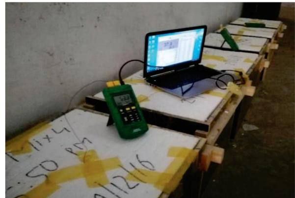
(d) COMPLETE SETUP FOR HEAT OF HYDRATION MEASUREMENT
