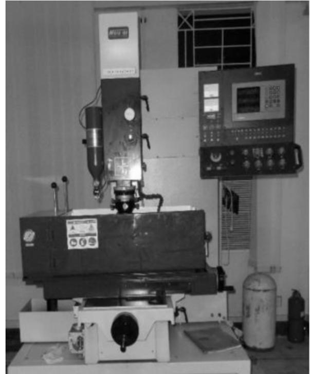
FIG. 1(a). ELECTRICAL DISCHARGE MACHINING
