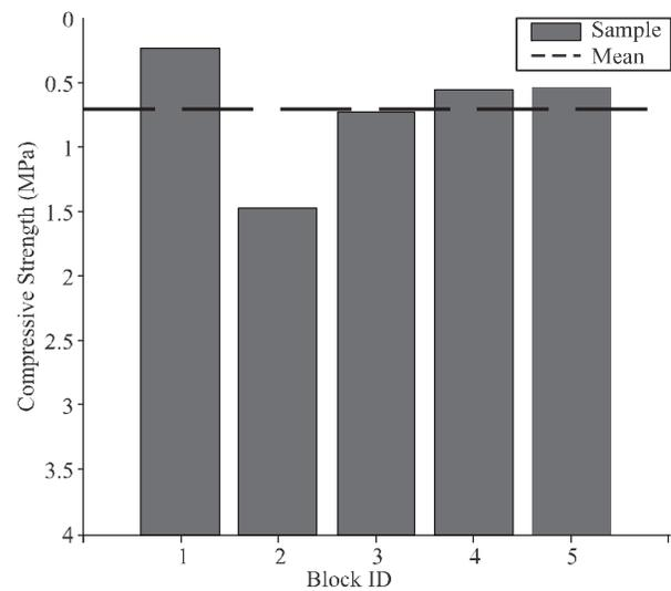
FIG. 2. COMPRESSION STRENGTHS OF TYPE-1 BLOCKS
