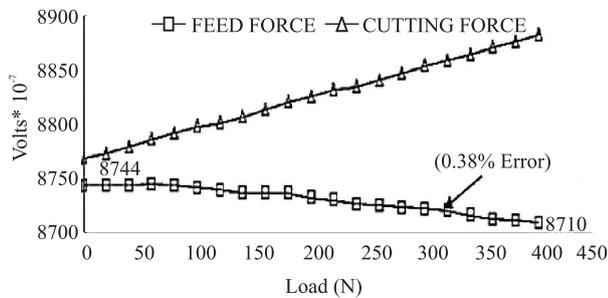
FIG. 6. CUTTING FORCE ARM CALIBRATION
