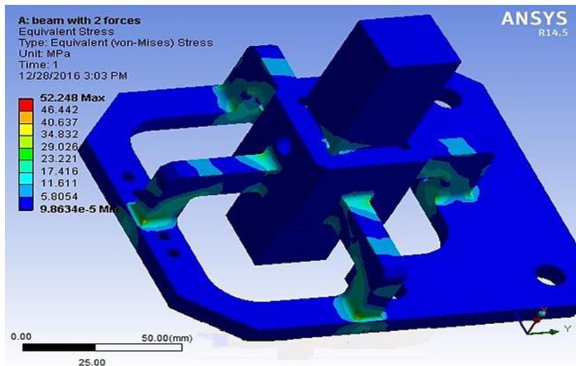
FIG. 1. VON MISES STRESS DISTRIBUTION
