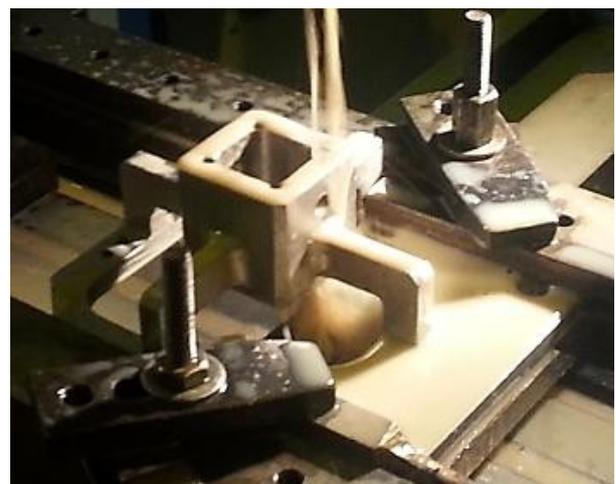
FIG.2(B) THE ACTUAL STRAIN GAUGE BASED DYNAMOMETER WHILE GOING THROUGH AN EDM PROCESS
