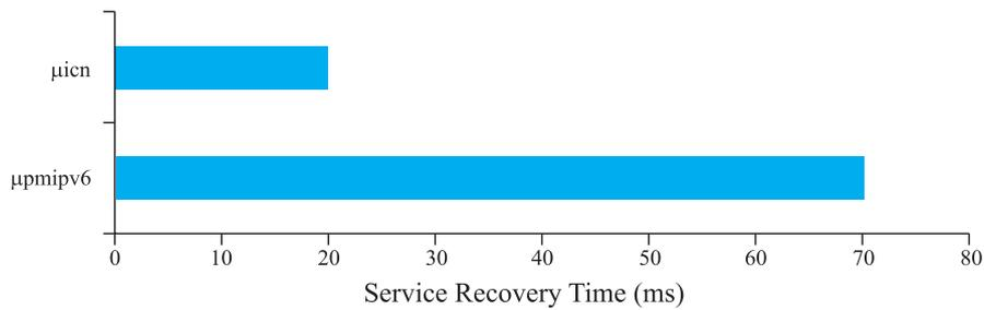
FIG. 3. SERVICE RECOVERY TIME FOR ICN AND PMIPv6
