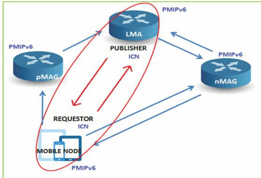
FIG. 1. BASIC NETWORK MODEL FOR PMIPv6 AND ICN
