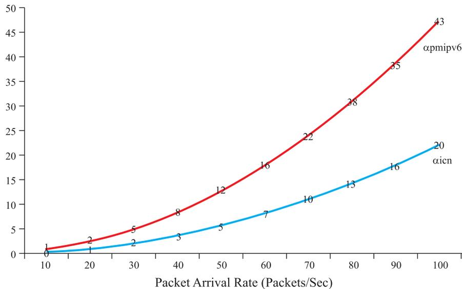
FIG. 5. PACKET LOSS COST FOR ICN AND PMIPv6 VERSUS PACKET ARRIVAL RATE
