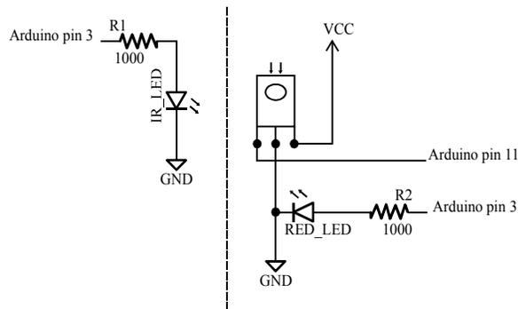
FIG. 2. CIRCUITS FOR SIMPLE IR TRANSMITTER AND RECEIVER
