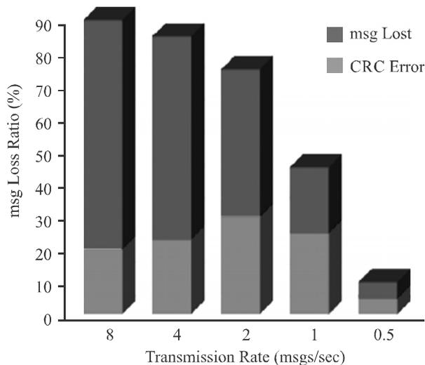
(b) MESSAGE LOSS RATIO VERSUS TRANSMISSION RATE
