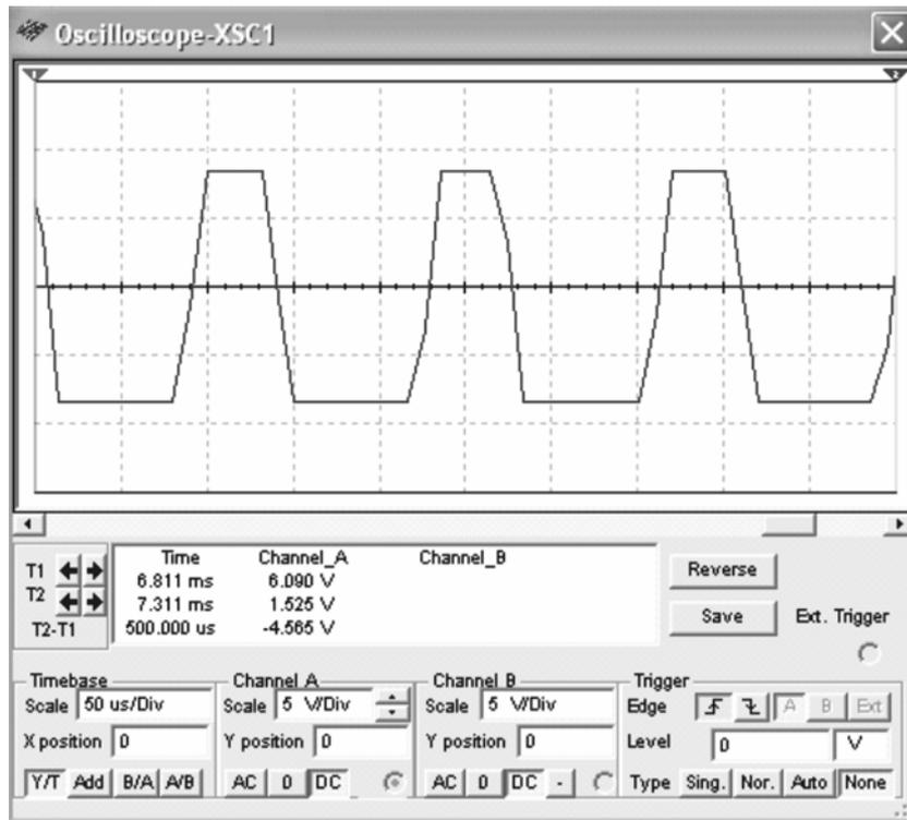
FIG. 6. PWM SIGNAL WHEN  $V_S=15V_{P-PK}$
