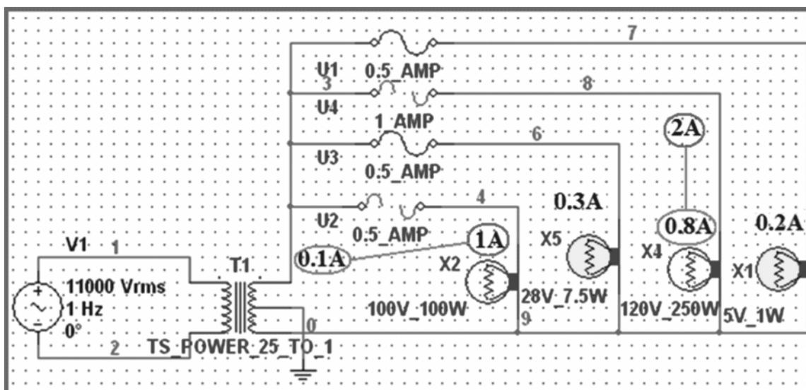
FIG. 8. SIMULATION RESULT OF CIRCUIT ON DISTRIBUTION STAGE
