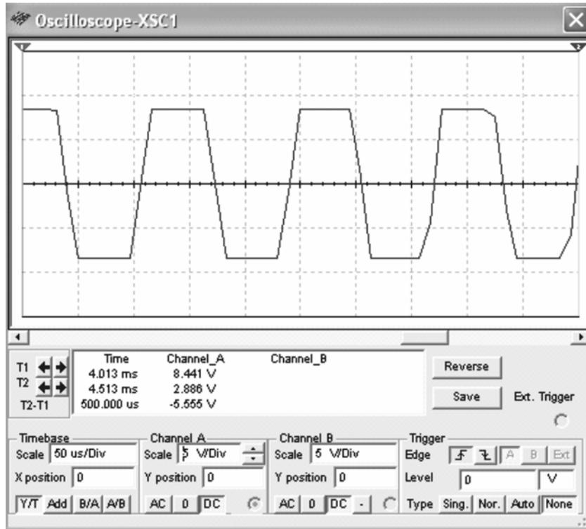
FIG. 4. PWM SIGNAL WHEN  $V_S=5V_{p-pk}$
