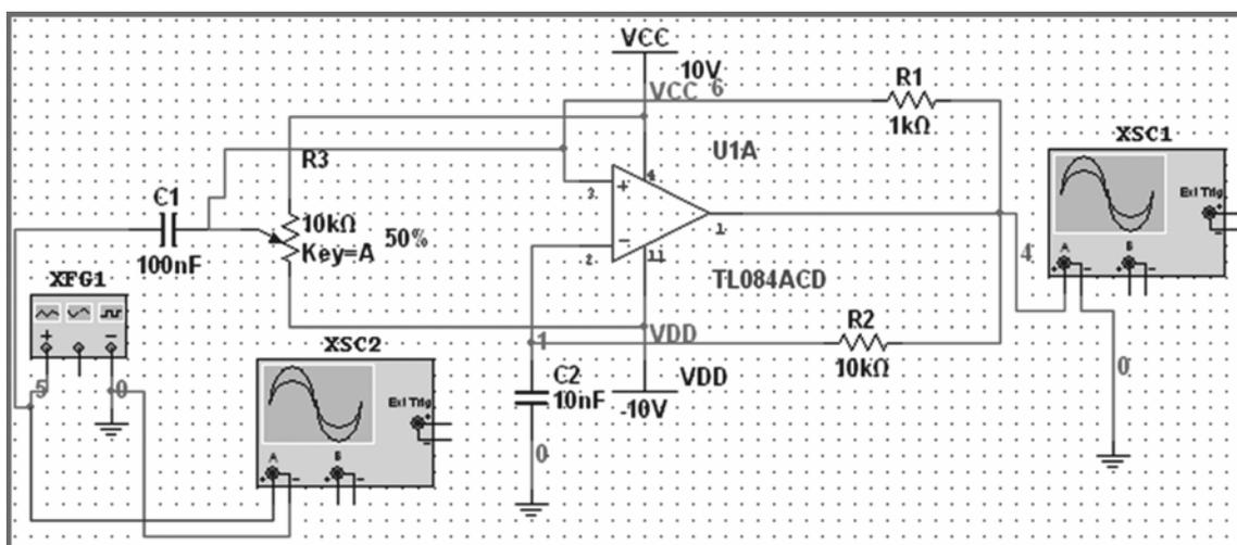
FIG. 2. SIMULATION CIRCUIT ON TRANSMISSION STAGE
