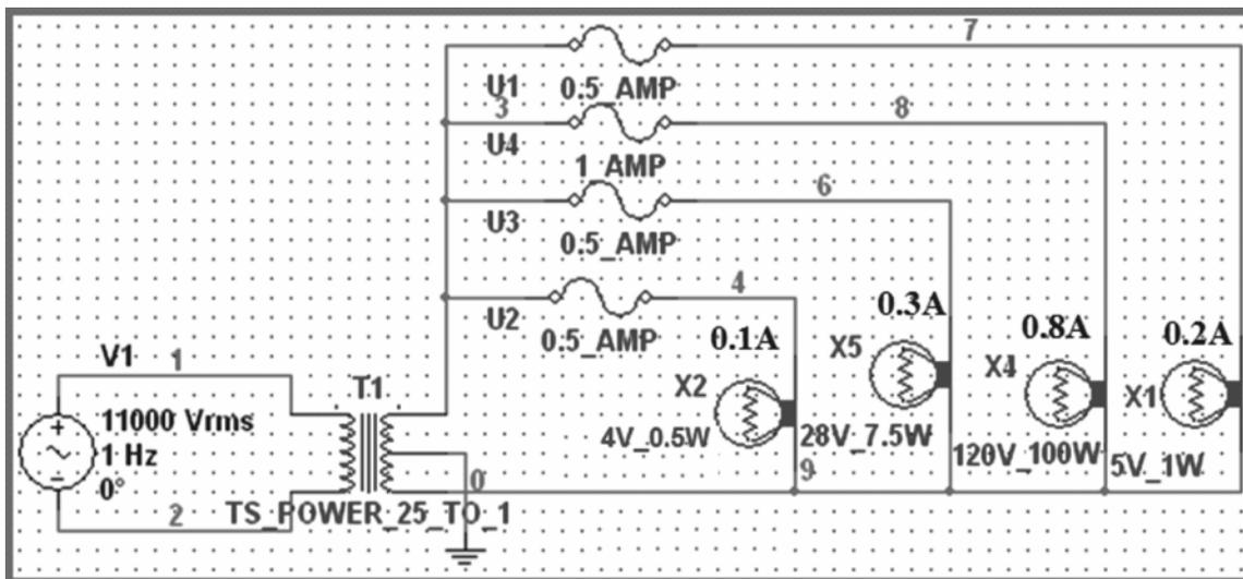
FIG. 7. SIMULATION CIRCUIT ON DISTRIBUTION STAGE
