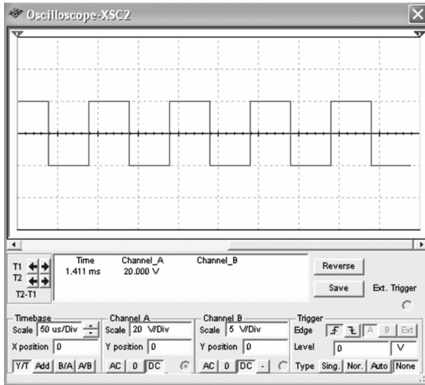
FIG. 12. SQUARE WAVE INPUT SIGNAL
