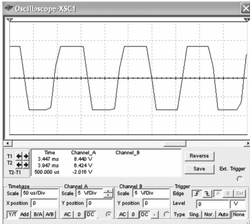
FIG. 5. PWM SIGNAL WHEN  $V_S=10V_{p-pk}$
