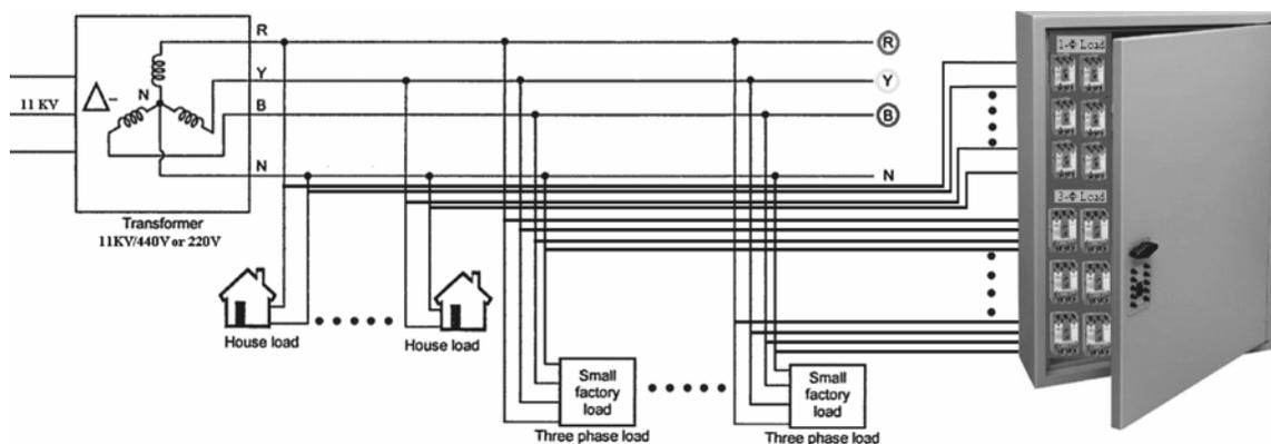
FIG. 9. THE PRACTICABLE LAYOUT ON THE DISTRIBUTION STAGE
