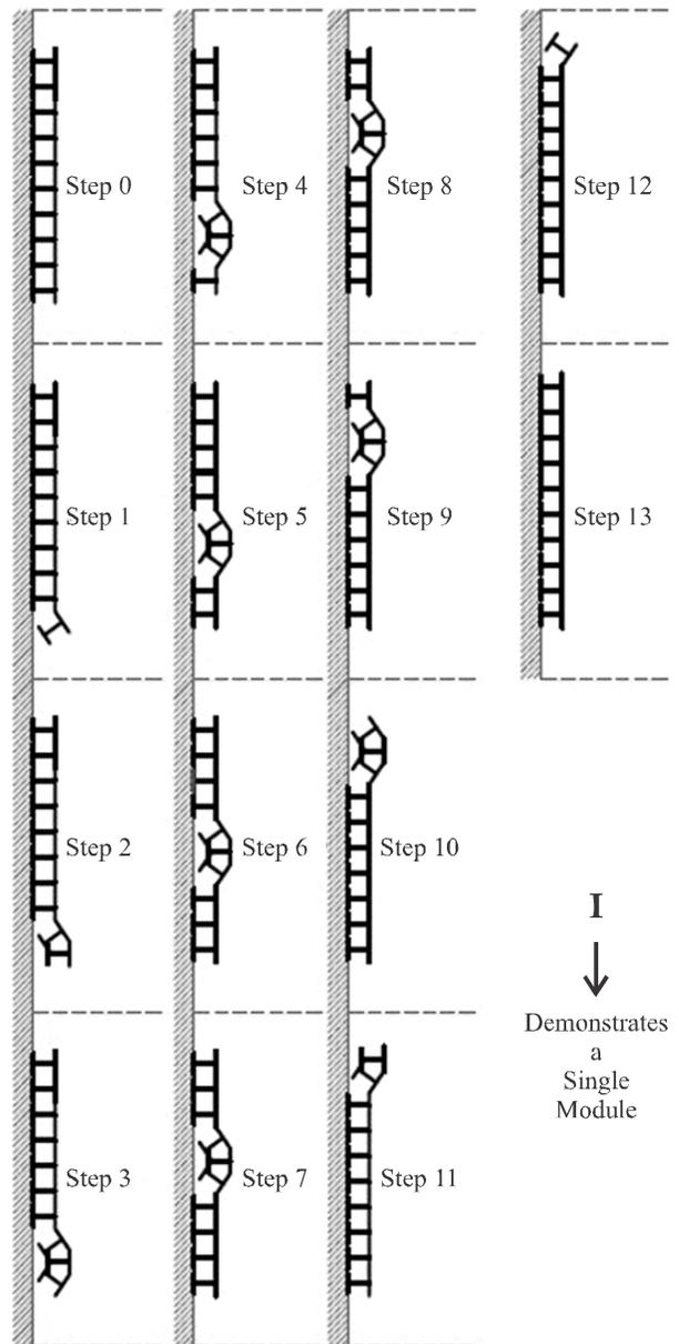
FIG. 7. THE DEMONSTRATION OF THE RECTILINEAR GAIT OF LOCOMOTION ON VERTICAL TERRAIN
