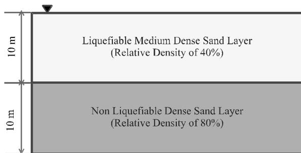
FIG. 2. THE SOIL PROFILE
