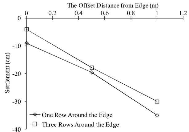
FIG. 7. SETTLEMENT OF FOOTING VERSUS OFFSET DISTANCE FROM PAD EDGE
