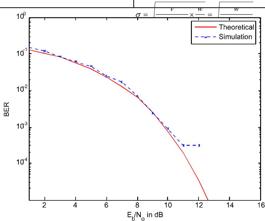
FIG. 4. BER VERSUS  $E_b/N_0$  FOR PDC-BASED OCDMA SYSTEM,  $w=14$ ,  $T_c=0.1$  NS
