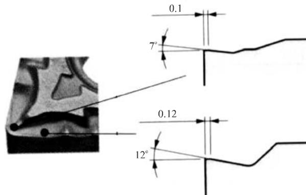
FIG. 2. CQ TYPE INSERT CHIP BREAKER GEOMETRY
