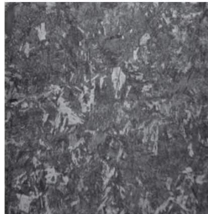
(d) LOWER BAINITE IN A SAMPLE AUSTEMPERED AT 300°C
