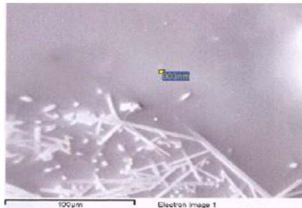
FIG. 11. DENTERIC GROWTH OF MULLITE IN SILICA REGION
