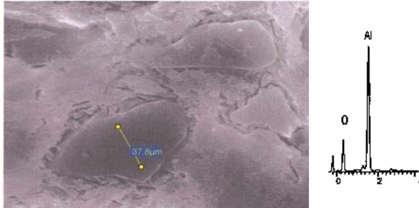
FIG. 7. REGION SCANNED OVER 37.8 μm IS PURELY ALUMINA, INSET EDS CONFIRMS THE CORUNDUM GRAIN
