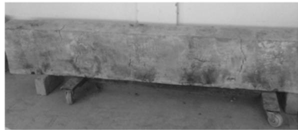
*FIG. 4. CLAY BEAMS BAKED WITH THE TREATMENT OF PLASTIC SHEET COVER BEFORE BAKING*
