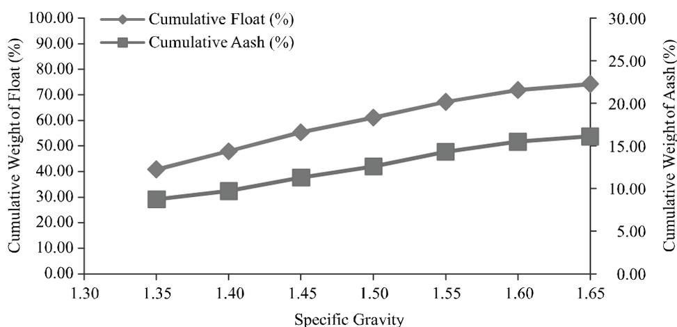
FIG. 2(a). WASHABILITY CURVES FOR SIZE FRACTION  $-0.5+0.3$ mm SHOWING CHANGE IN ASH CONTENT
